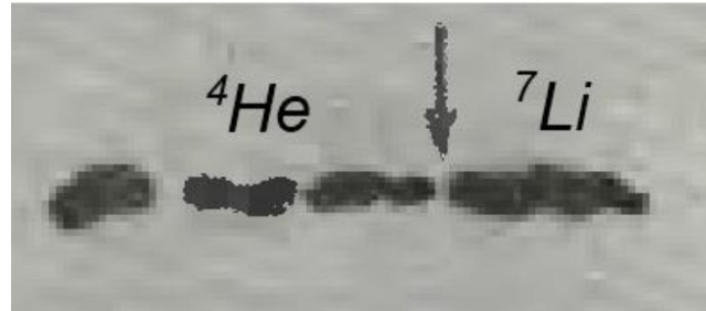
Рисунок 3 – Пример события расщепление тепловыми нейтронами ядра атома бора. На рисунке отчетливо можно различить треки ядер {}^4\text{He} и {}^7\text{Li} .
