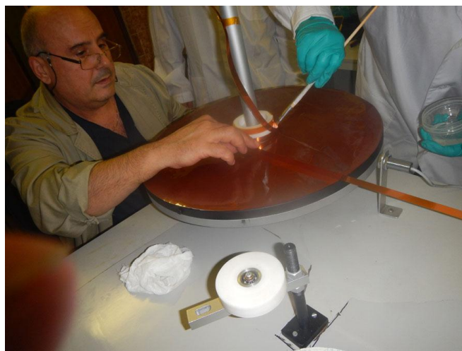
Рис. 4.3. - Изготовление обмотки магнита на станке.
