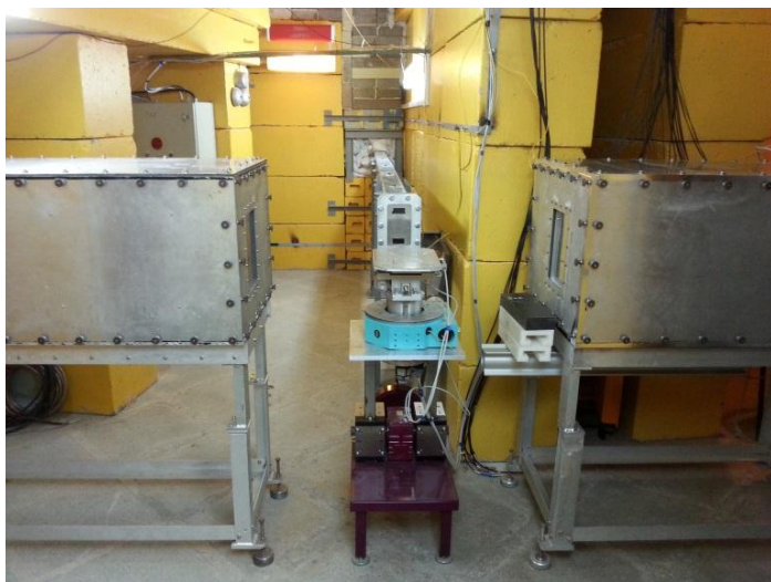
Рис.3.5. Стол образца с гониометром и 90° сцинтилляционные детекторы “Ost” и “West” на 13 канале ИБР-2.
