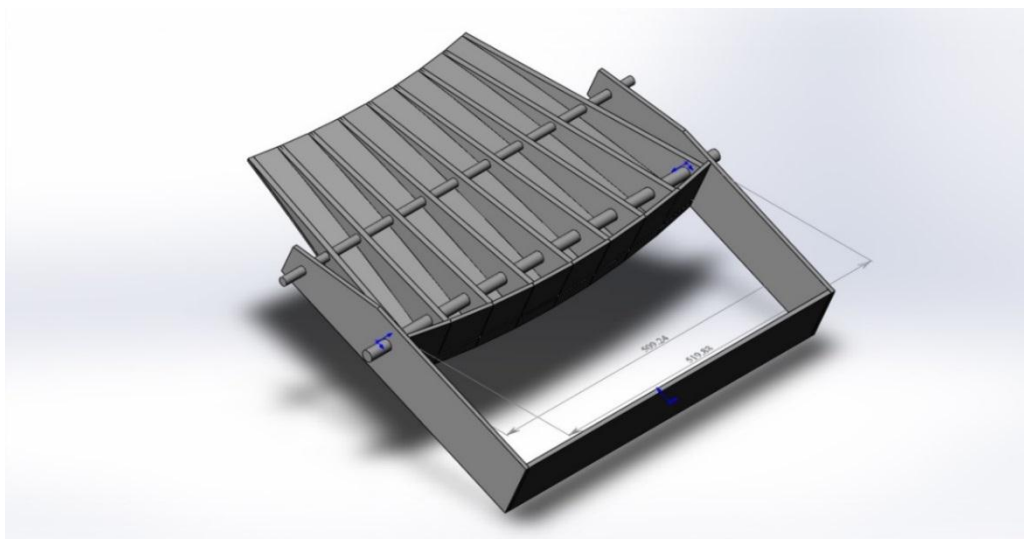
Рис.5.10. Трёхмерная модель одной из плоскостей нового детектора АСТРА-М.
