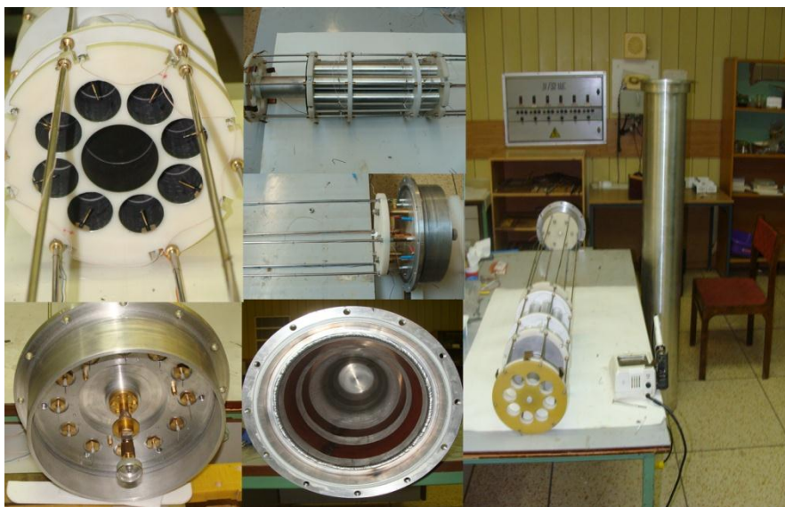
Рис.5.3. Корпус и электродная система телескопа протонов отдачи.
