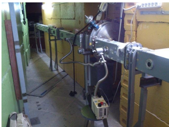
Рис. 3.1 Начальный участок изогнутого нейтронвода и Фурье-прерыватель на 13 канале ИБР-2.
