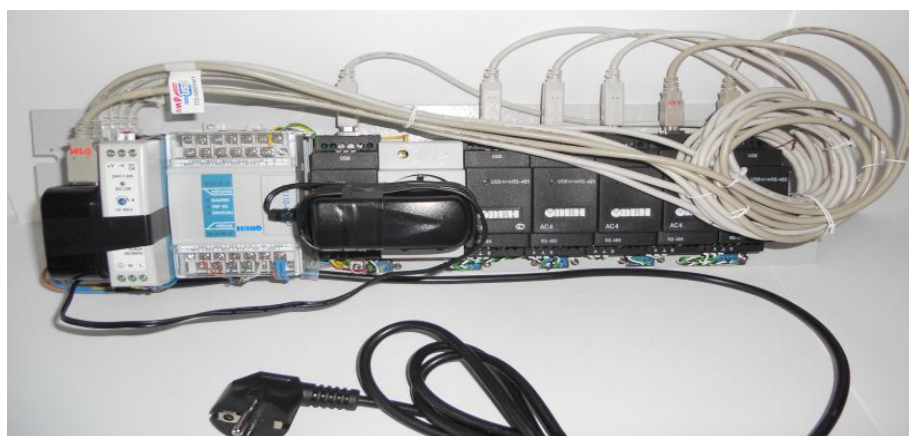
Рис.6.5. Система контроля состояния установки на базе преобразователей интерфейсов AC4 (USB-RS485) и AC3-M (RS485-RS232).
