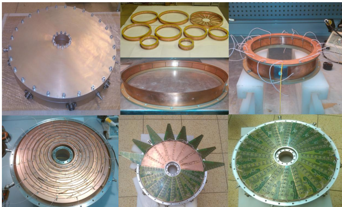
Рис.5.2. Фотографии корпуса, внутренней части детектора и 9 независимых коаксиальных колец.
