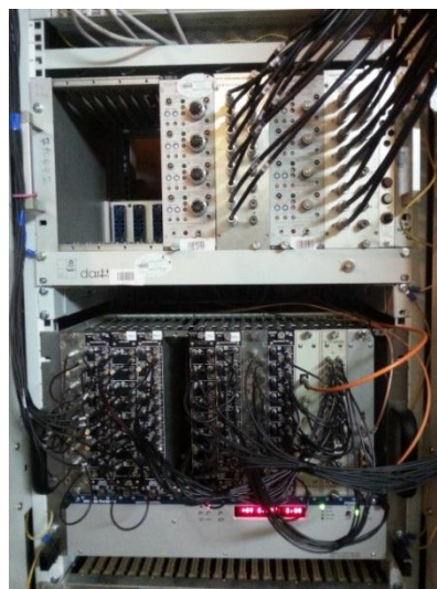
Рис.3.6. Электроника в/в питания детекторов (верхний крейт), блоки детекторной электроники и электроники накопления данных (нижний крейт).
