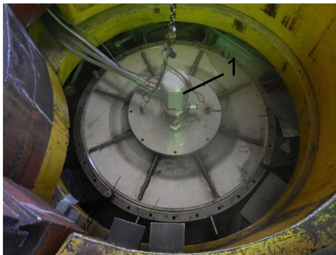
Рис. 4.5. Фотография криостата с криорефрижератором в шахте спектрометра ДИН-2ПИ.
