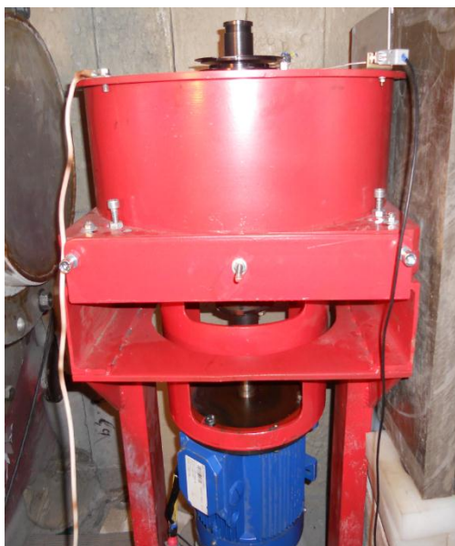
Рис. 6.7. Новый прерыватель барабанного типа на спектрометре РЕФЛЕКС.
