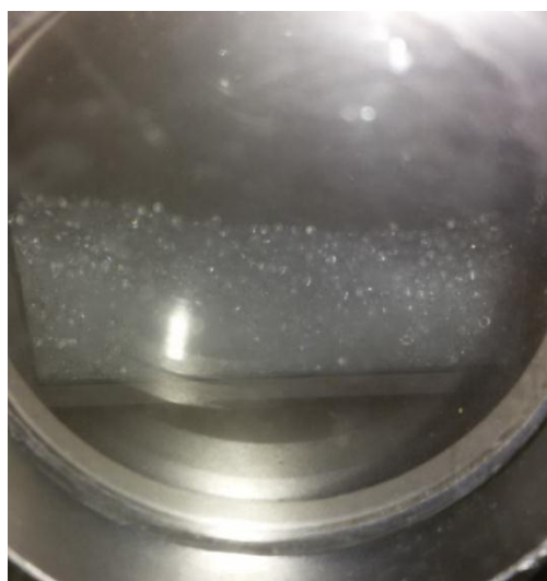
Рис.1.2. Снимок камеры во время проведения эксперимента. Температура внутри камеры T = 80 \text{ К} . Загружено ~ 15000 шариков (0,5 л).
