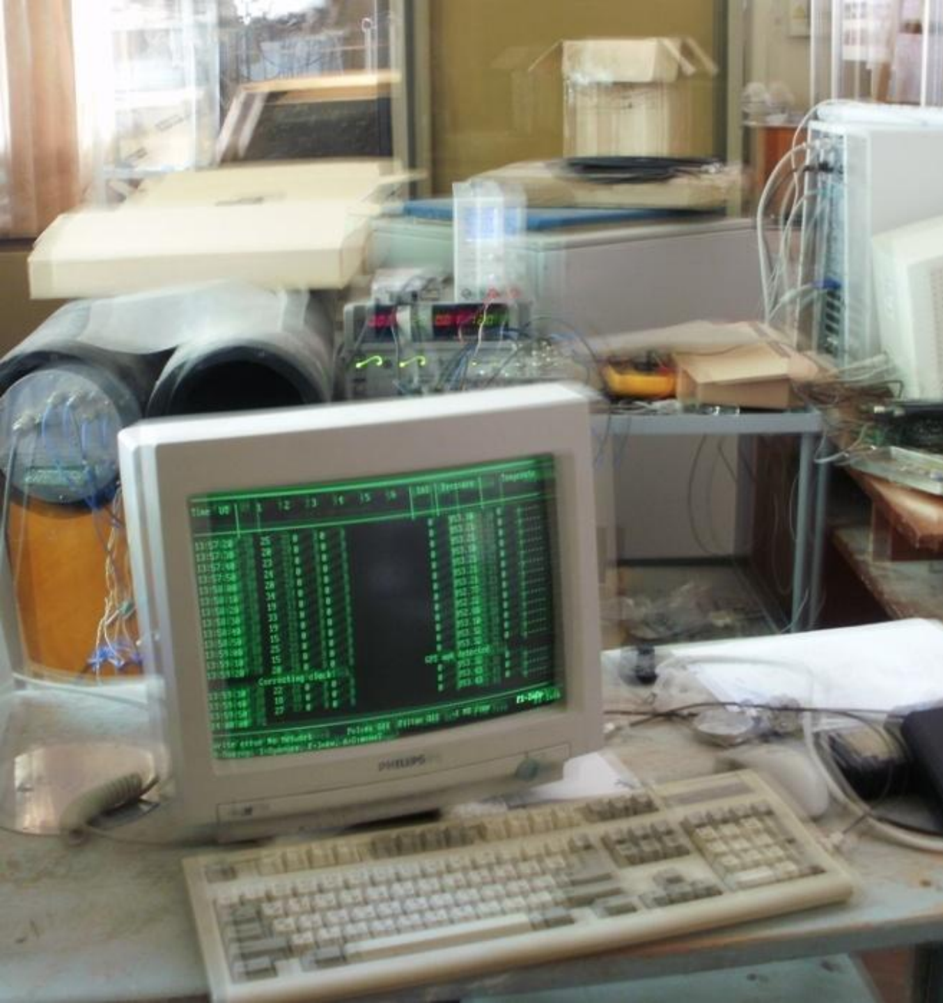
Стенд для проверки счетчиков СММ-15 в лаборатории АФКЛ
